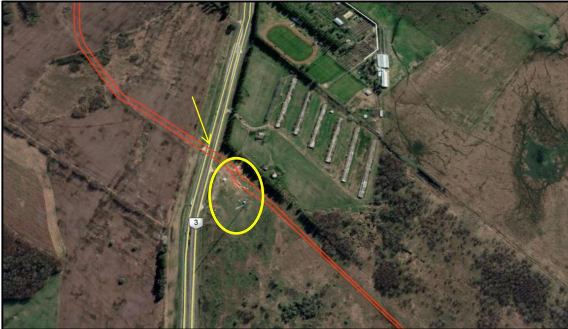
*Imagen N° 2.1: Planta Cañuelas – TGS (circulo en amarillo). El gasoducto previo a arribar a la planta pasa por debajo de la ruta N° 3 (flecha amarilla). En este tramo, el tabajo se realizará con tunelera.*
